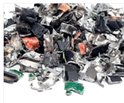
Rozdrobnione dyski twarde Rozmiar ścinka: 11,5x26 mm (<299 mm 2 ). Stopień bezpieczeństwa: H-5
