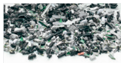
Rozdrobnione pamięci USB. Rozmiar ścinka: 11,5x26 mm (299 mm 2 )
