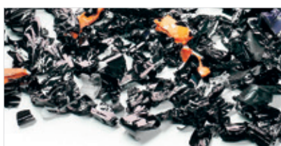
Rozdrobnione taśmy magnetyczne, karty plastikowe. Rozmiar ścinka: 11,5x26 mm (299 mm 2 ).
