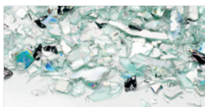
Rozdrobnione płyty CD, DVD i Blu-ray. Rozmiar ścinka: 11,5x26 mm (299 mm 2 ).
